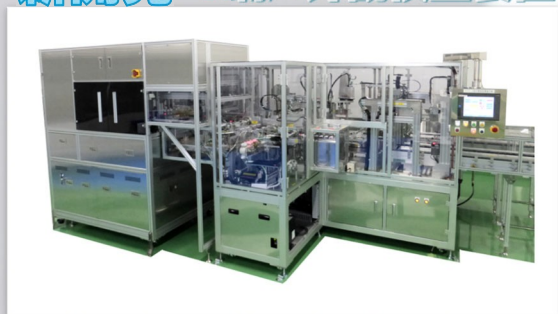
シリンジ X線+外観検査装置
